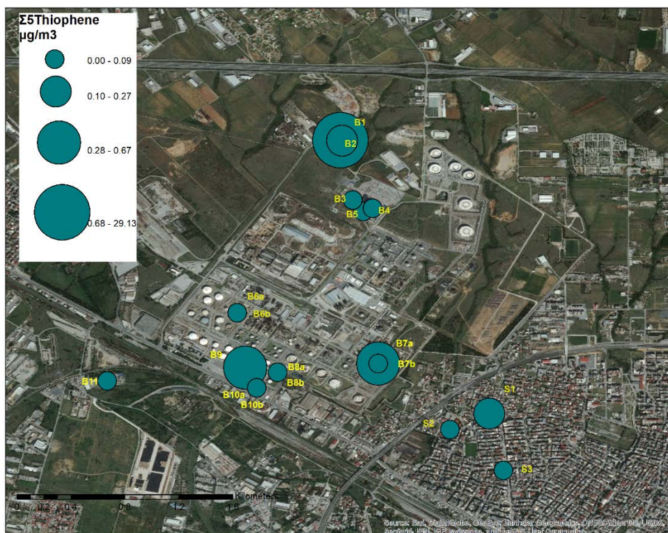
Διάγραμμα 3.25: Συγκεντρώσεις θειοφαινίων ( \Sigma_5 Thiophenes) σε βιομηχανικές εγκαταστάσεις που δραστηριοποιούνται κοντά στο Δ.Δ. Κορδελιού. Τα S1, S2, S3 απεικονίζουν τις μέσες συγκεντρώσεις θειοφαινίων στις τρεις αστικές θέσεις δειγματοληψίας.
