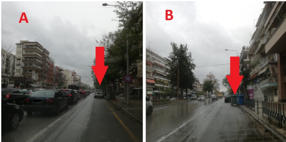
Εικόνα 5. Λεωφόρος Καραμανλή: (Α) Ένα και μόνον ένα σταθμευμένο όχημα ακυρώνει τη χρήση λωρίδας, παρά την απομάκρυνση όλων των άλλων σταθμευμένων οχημάτων, (Β) Κάδοι απορριμμάτων ακυρώνουν επίσης τη χρήση της λωρίδας.
