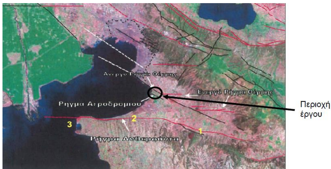
Εικόνα 6.6.2β: Δορυφορική εικόνα με τα κύρια ίχνη ρηγμάτων στην ευρύτερη περιοχή του έργου (Zevnroulou et al, 2007)
